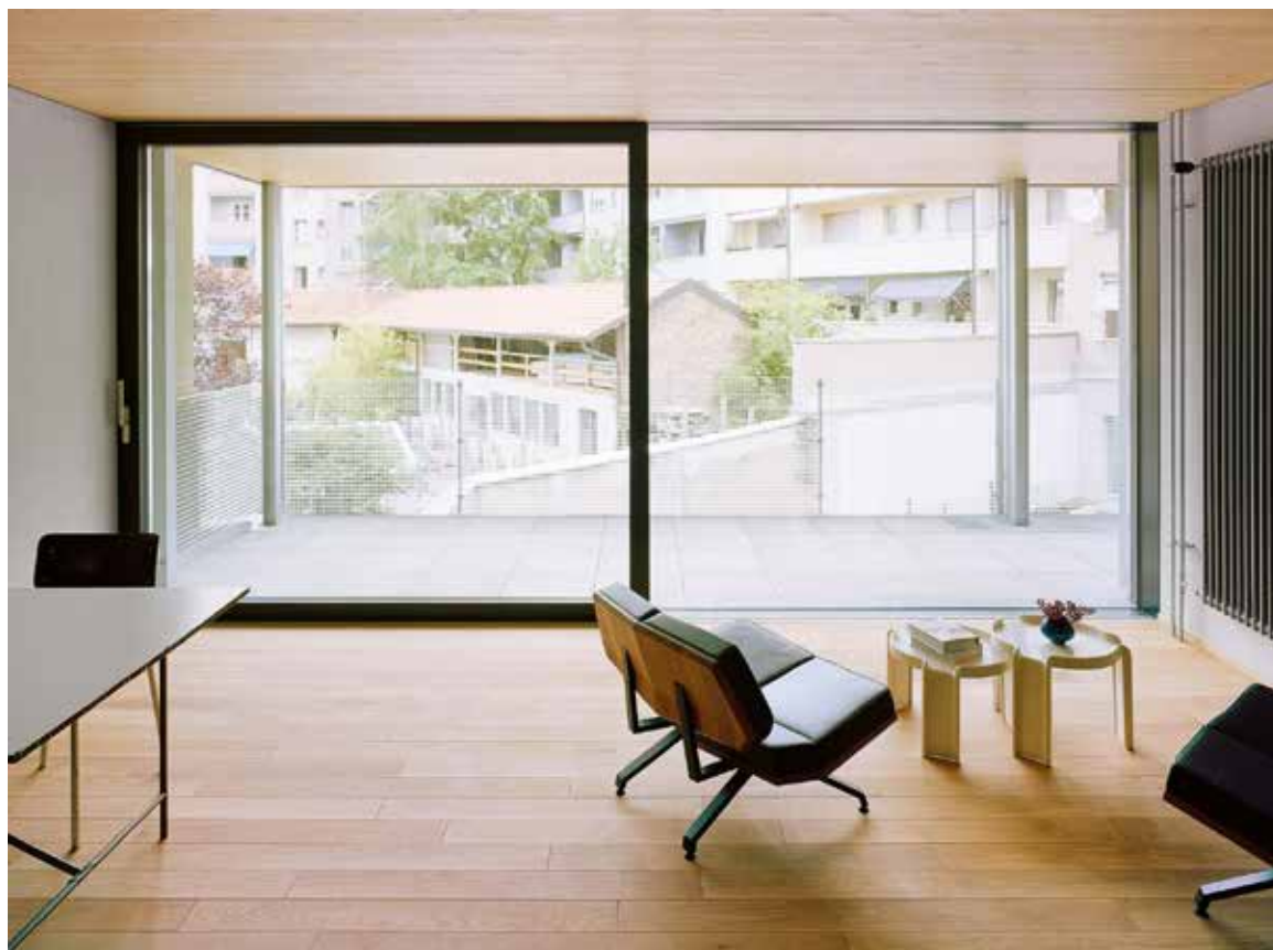
Radiatoren und elektrische Installationen sind aufputz montiert. Der Wohnbereich öffnet sich über deckenhohe Schiebefenster zur grosszügigen Terrasse und dem Innenhof. Der Terrassenboden ist mit wiederverwendeten Gartenplatten belegt und unterseitig mit Fichtenholz verkleidet, als Geländer dienen industrielle Pressroste.
